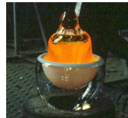
C Eine Blase aus farblosem Glas wird in rotglühendem Zustand in den weißen Trichter gedrückt.
