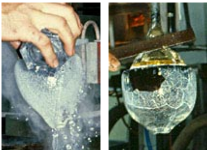
E Die äußere Hülle des Trichters wird mit Wasser abgeschreckt ...
