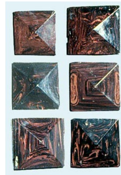
8 Sechs pyramidenförmig geschliffene Steinchen aus lebrigem, inhomogenem Kupferrubinglas mit heller Äderung aus dem von G. E. Pazaurek zusammengestellten Musterbuch.
