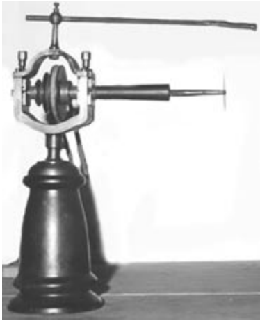
Abb. 6 Gravurapparat aus der ersten Hälfte des 19. Jahrhunderts mit zwei Stufenscheiben für drei Umdrehungsgeschwindigkeiten. Glasmuseum Frauenau.
